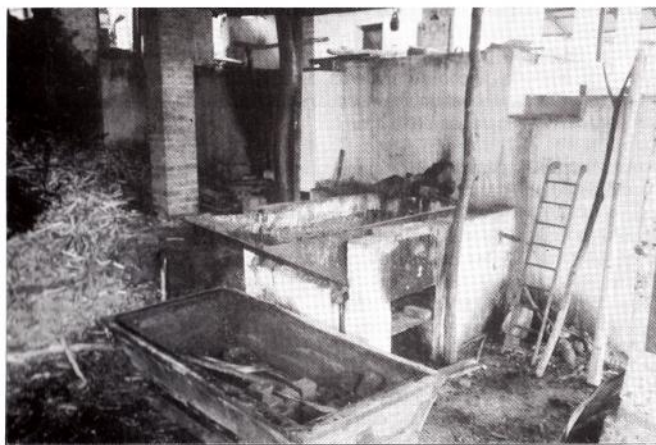
La miel, ya cocida y espesada, es vertida de la última plana, a la canoa de removido, de donde pasa a los moldes.
