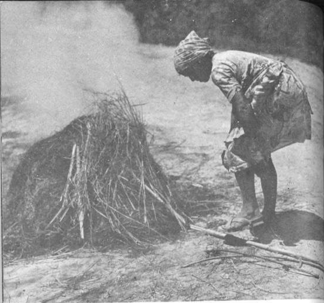
Quema de vasijas en horno al aire libre. Se emplea paja y chiribiscos.
