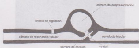
Fig. 5 Dibujo técnico de un silbato de la primera variante con definición de los distintos elementos organológicos. (Dibujo modificado por A. A. Both y V. Rodens).
