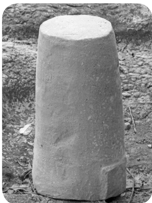
Filtro terminado en forma invertida.
