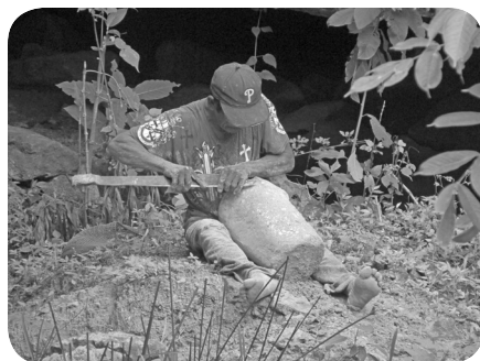
Con el machete alisa la pared externa del filtro.
