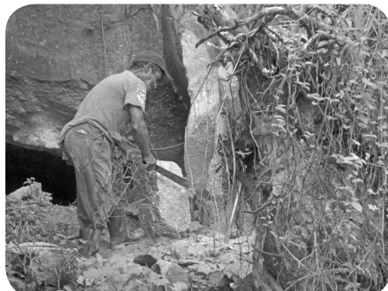
Con el machete le da forma al trozo de piedra.
