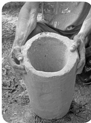
El filtro en posición correcta. Obsérvese el vaciado de la piedra, en donde se colocará el agua para que filtre.
