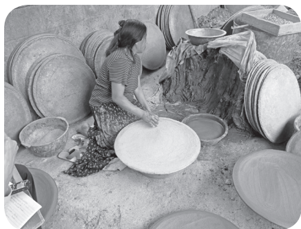
Molde para comal, cubierto con polvo de cascahuín.
