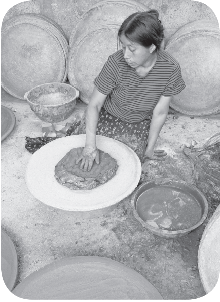
Coloca el barro al centro del molde y lo palmea.
