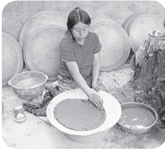
Extensión del barro sobre el molde.
