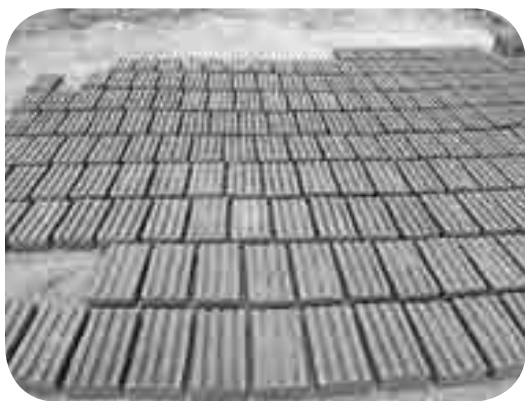
Ladrillos secándose bajo el sol.
