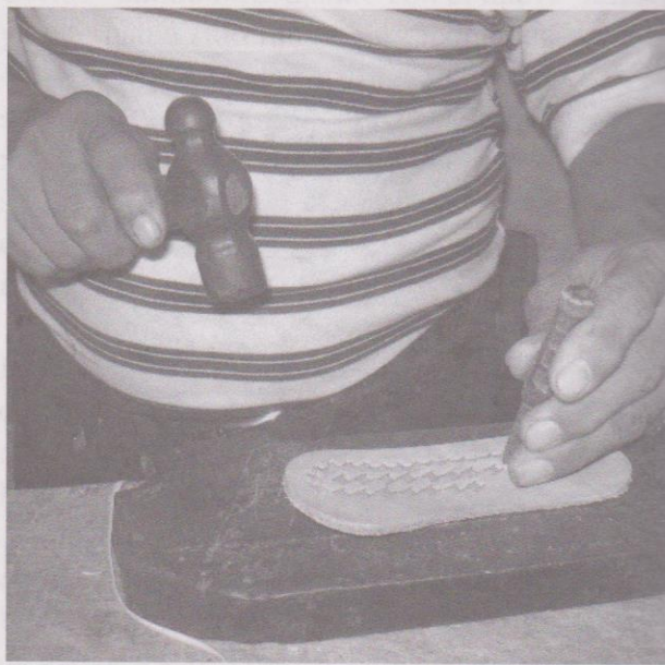
Don Carlos cincela una pieza para fabricar un monedero. El arte de cincelar consiste en hacer diseños sobre la pieza con el cincel.
